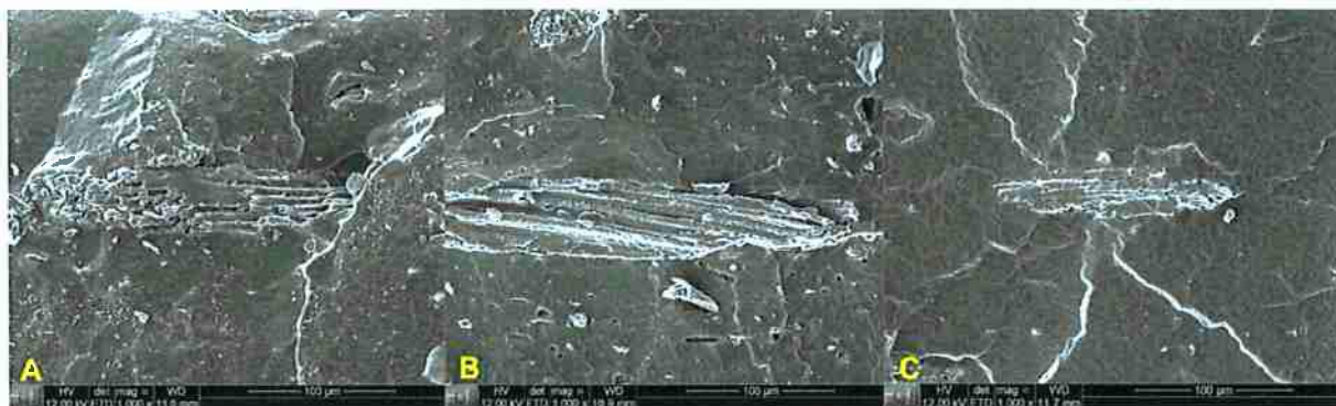
Figura 22 - Variação do tamanho dos aglomerados de carga em CP com diferentes concentrações de carga. A - 10PHR; B - 8PHR; C - 6PHR.
