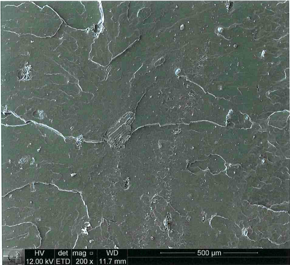
Figura 25 - Borracha Natural contendo 4 PHR de Piaçava. Aumento de 200x
