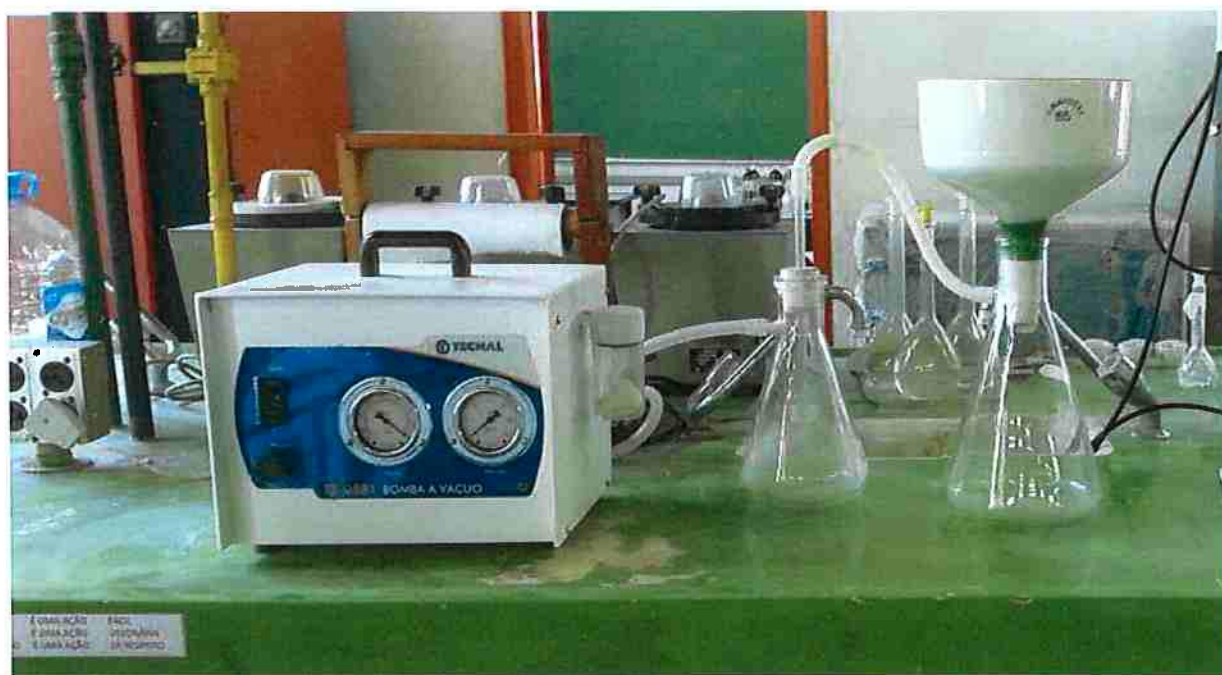
Figura 13 - Montagem dos equipamentos para lavagem da bentonita
